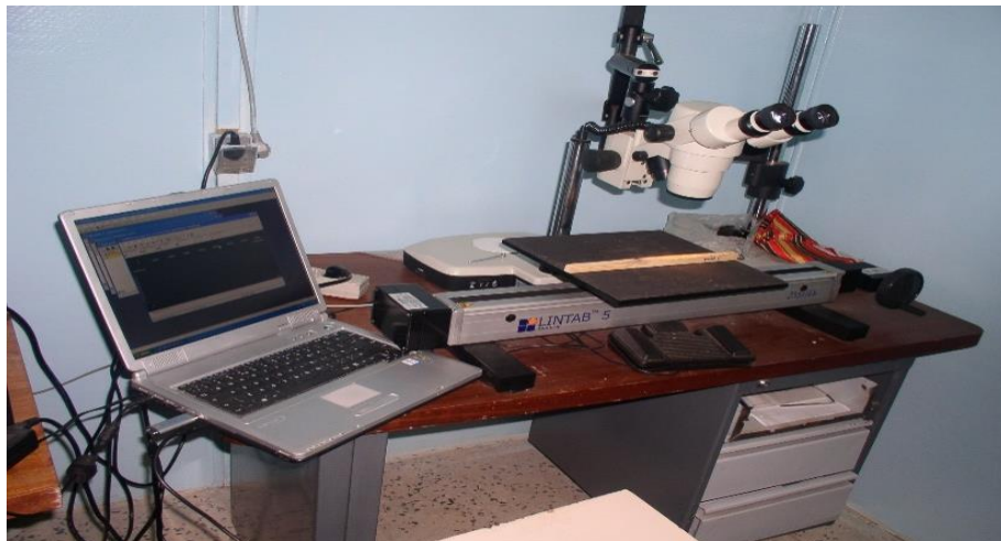
Figure.8. : La machine LINTAB5 d'inter-datation et de mesure des épaisseurs des cernes.
