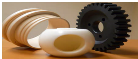
Figure I-11 : Exemple de pièces obtenues par injection plastique.
