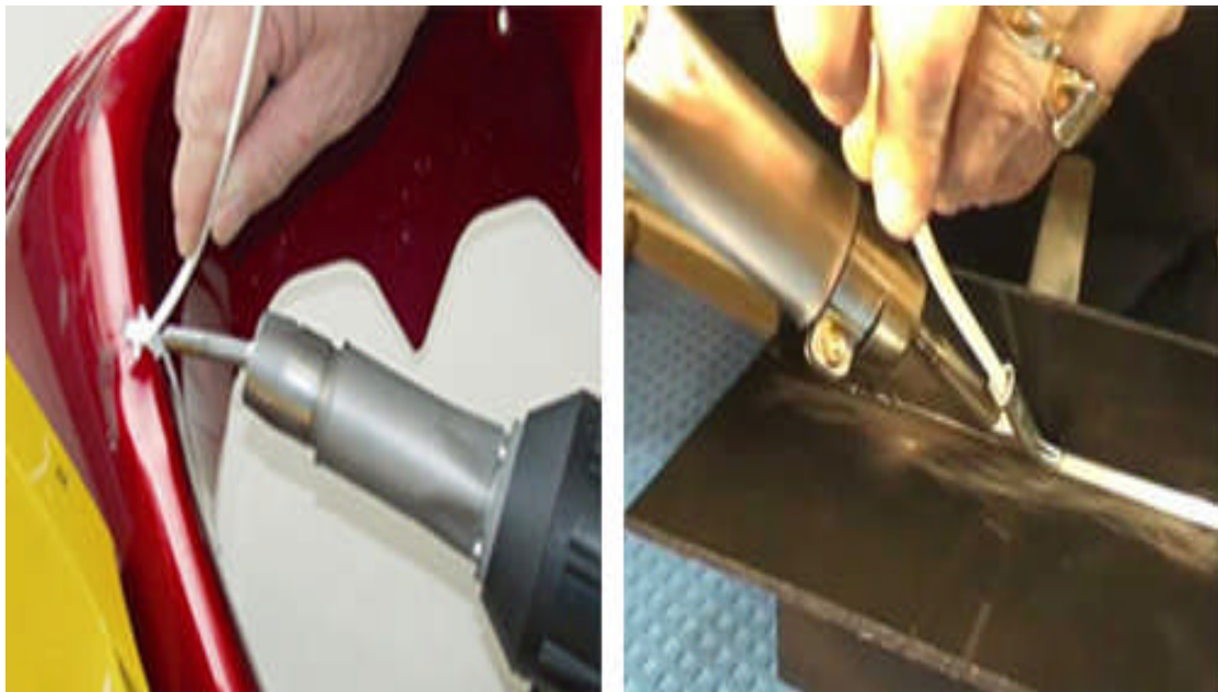
Figure II-2 : Soudure a gaz chaud.
