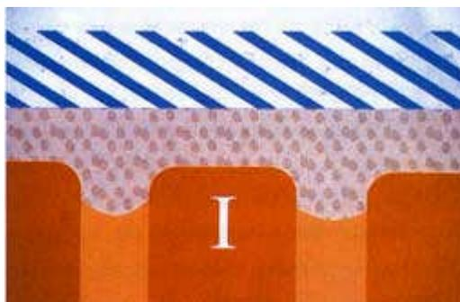
Figure 43: Représentation schématique de l'adhésif de 1<sup>ère</sup> génération.
