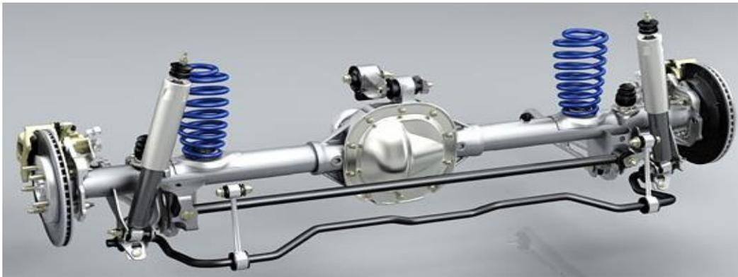
**Figure II.1:** Pont moteur arrière.
