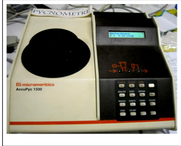
Figure II-11 : Pycnomètre à hélium AccuPyc 1330 .
