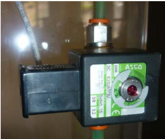
**Figure II-3 : Schéma de l'électrovanne proportionnelle**
