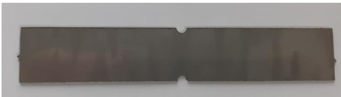
Figure II.23 Eprouvette entaillée r = 2\text{mm} destinée à l'essai de traction.
