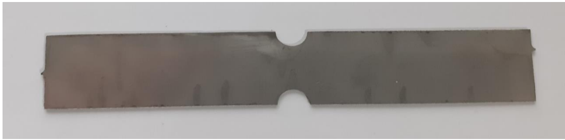
Figure II.24 Eprouvette entaillée r = 4\text{mm} destinée à l'essai de traction.
