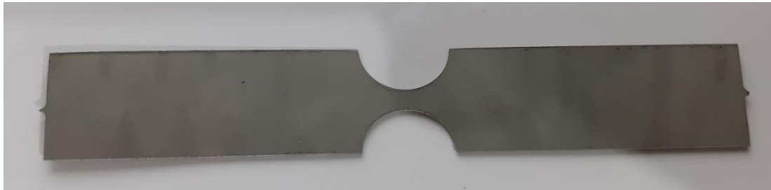
Figure II.25 Eprouvette entaillée r = 8\text{mm} destinée à l'essai de traction.
