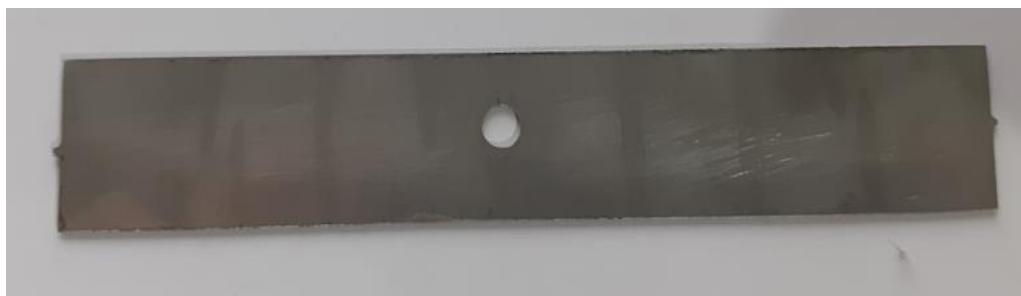
Figure II.22 Eprouvette trouée destinée à l'essai de traction.
