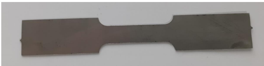
Figure II.21 Eprouvette standard destinée à l'essai de traction.
