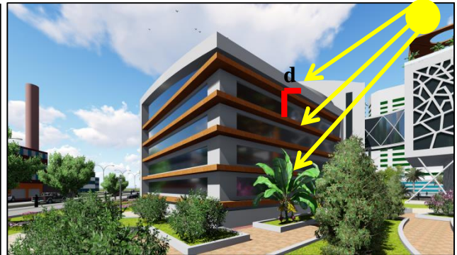
Figure150 : Calcul de la dimension du débord de toiture en fonction de la hauteur du soleil. Source : Auteurs.
