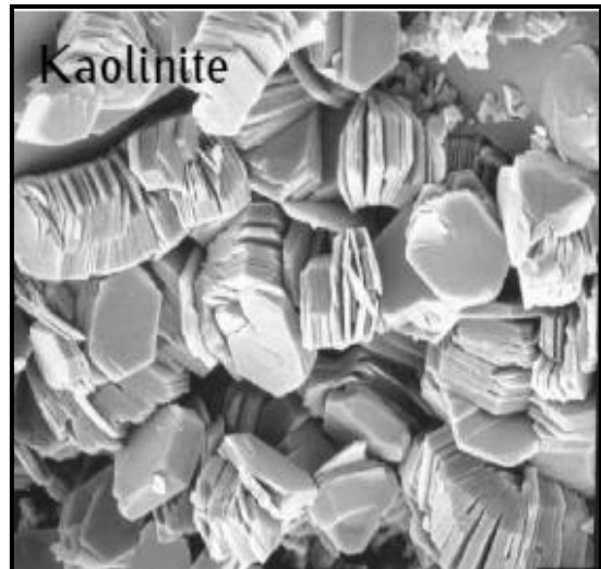
Figure I.5. Structure de la kaolinite (Grim;1962) Figure I.6. Photographie d'une kaolinite vue au microscope électronique
