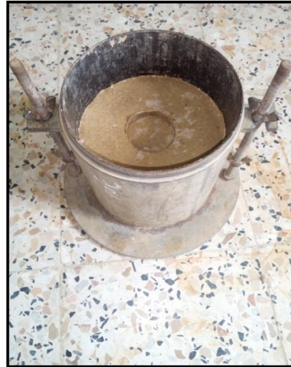
Figure III.21. Eprouvette après poinçonnement
