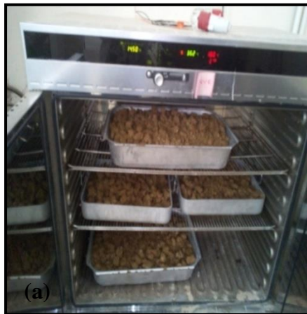
Figure III.3. Des échantillons soumis au séchage (a) ; une étuve (b)
