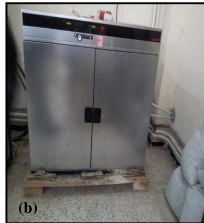
Figure III.3. Des échantillons soumis au séchage (a) ; une étuve (b)
