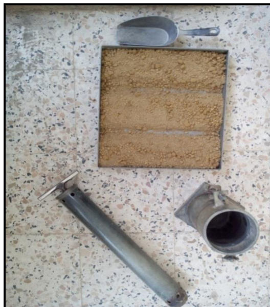
Figure III.17. Dispositif de l'essai Proctor
