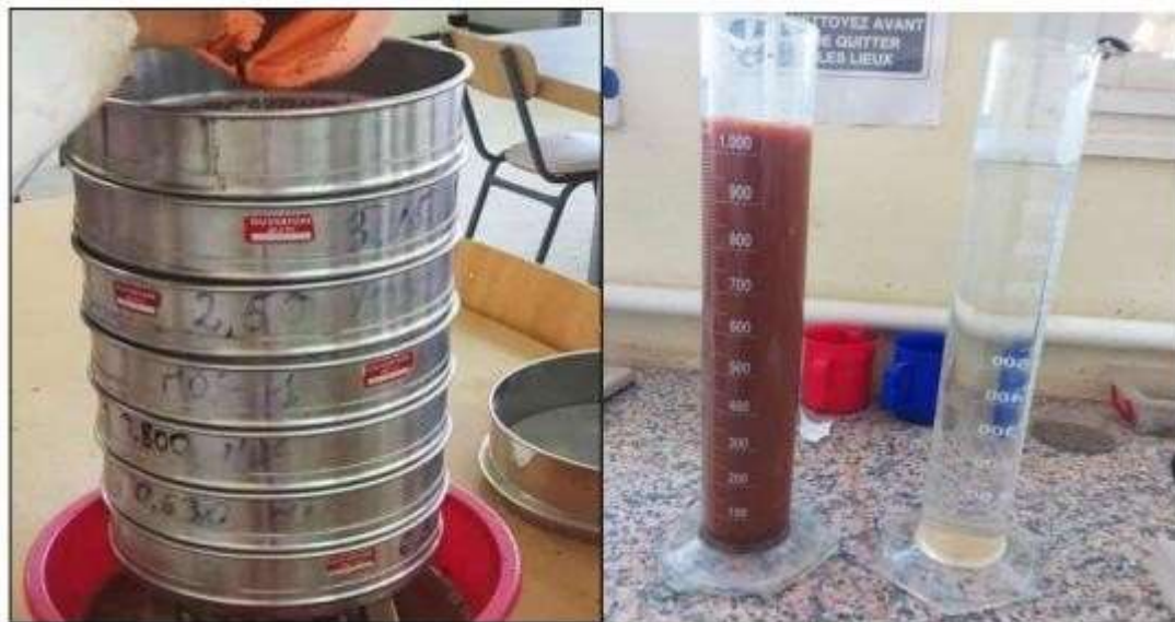
Figure III.3. Appareillage de l'analyse granulométrique par tamisage et sédimentation.
