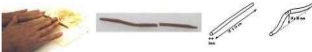
Figure III.8. Rouleaux pour la détermination de la limite de plasticité.
