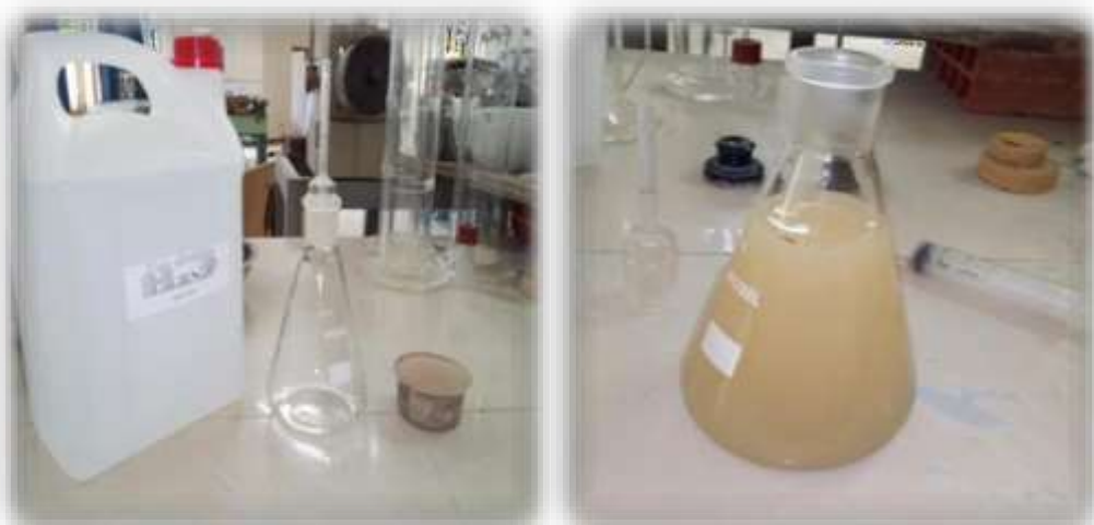
Figure III.5. Matériel nécessaire pour la détermination de la masse volumique des particules solides du sol.
