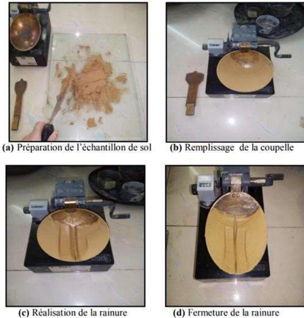
Figure III.6. Détermination de la limite de liquidité ( W_l )
