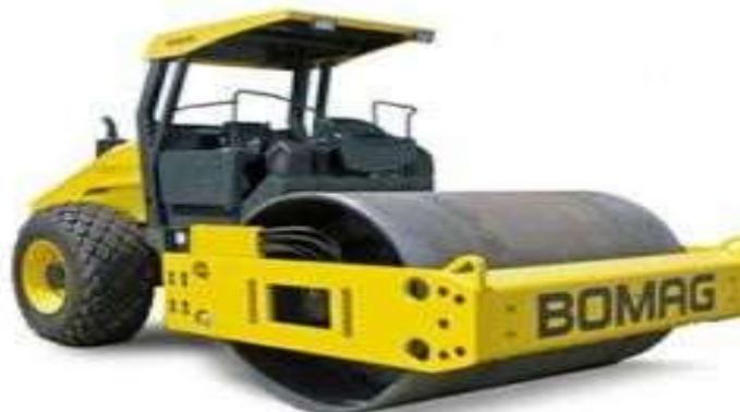
Figure II.22. Rouleaux compacteurs pour traitement des sols argileux.
