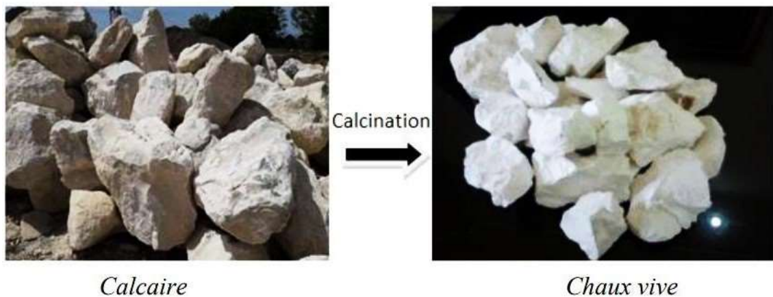
Figure II.7. Transformation du calcaire en chaux vive
