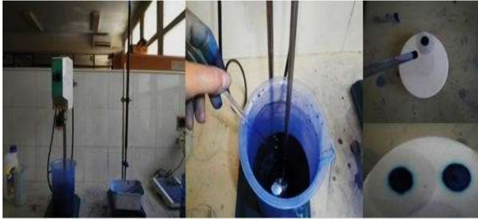
Figure III.10. Appareillage pour essai bleu de méthylène.
