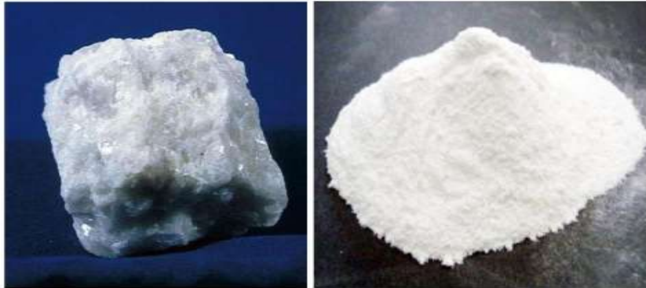
Figure II.16. Roche métamorphique de marbre (à gauche) poudre de marbre (à droite)
