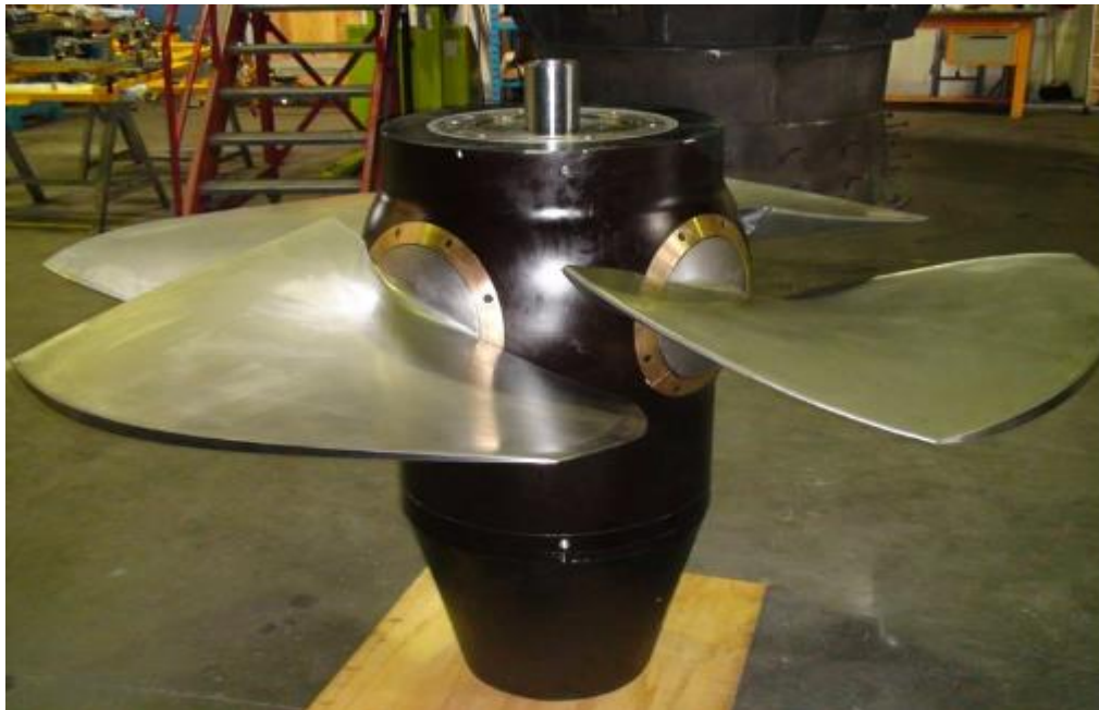
Figure I.3-c : turbines de type Kaplan.
