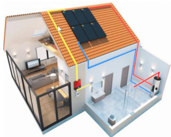
Figure I-63: Figure : fonctionnement d'un panneau solaire hybride.
