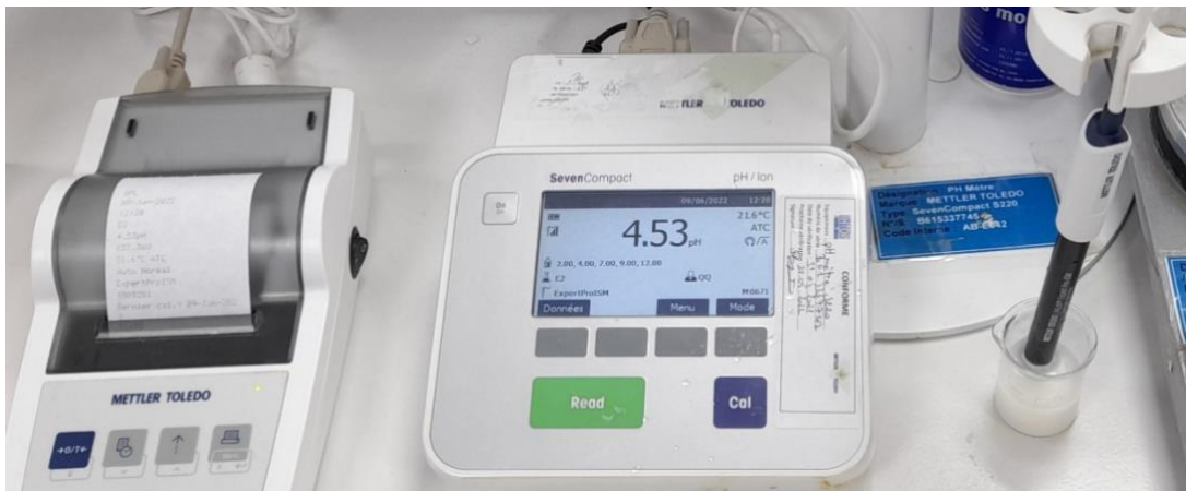
Figure 11: Représentation du test de mise en suspension et le contrôle de pH.
