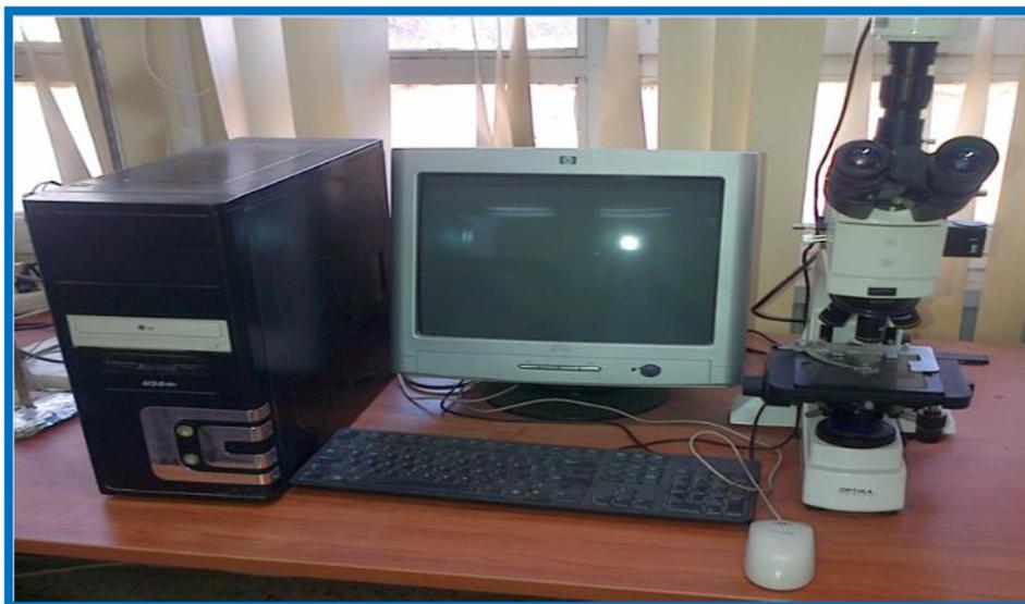
**Figure II.16 :** *Le Microscope Optique utilisé pour photographier la surface des échantillons (laboratoire LPCM).*
