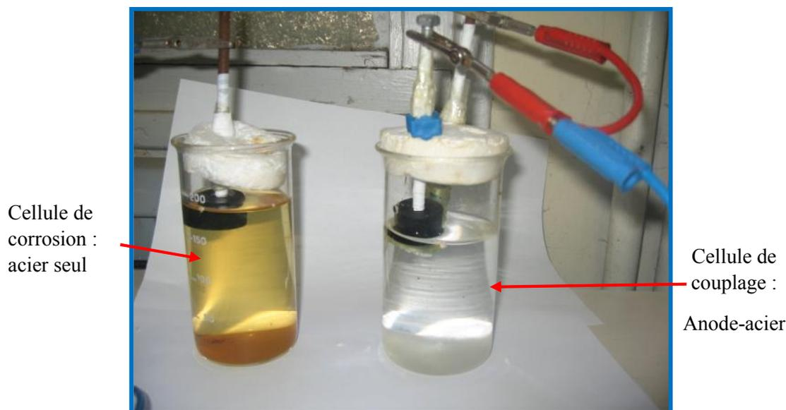
**Figure III.16 :** Photographie des deux solutions de protection par couplage et celle de la corrosion libre de l'acier.
