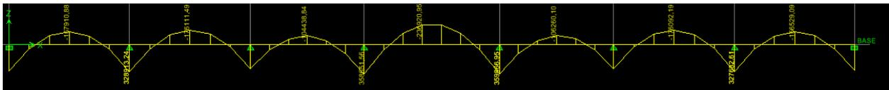
Figure VI.7 schéma statique de chargement de la nervure a l'ELS.
