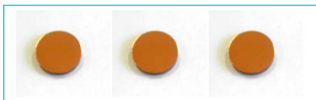
*Figure III.3. Photographie des pastilles de cuivre utilisées pour le dépôt des couches minces*
