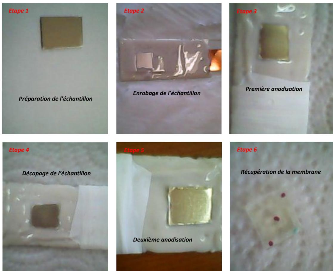
**Figure III.4.** Photographie des différentes étapes à franchir pour l'élaboration des membranes d'alumine,  $E=40V$ ,  $T=17^{\circ}C$ , acide oxalique 0.5 M
