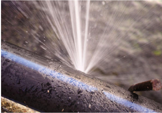
Figure I. 5: Éclatement de la conduite
