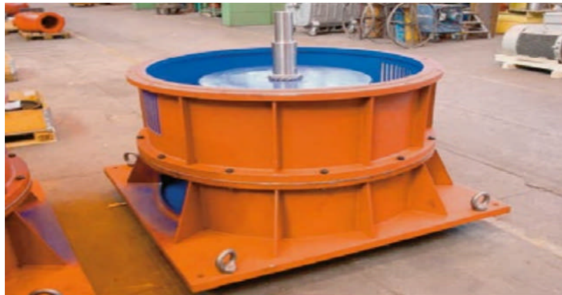
Figure II. 1: Volant d'inertie vertical.(Entraînement par l'intermédiaire d'un arbre articulé, D = 790 \text{ mm} )
