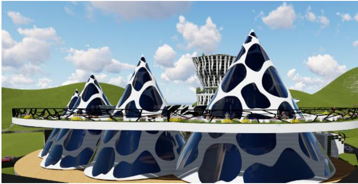
Couverture des serres en ETFE
