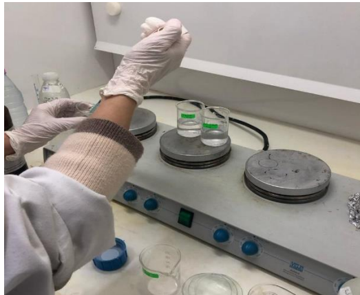
Figure N° 10. Traitement des échantillons avec de l'acide nitrique (Photo Originale)
