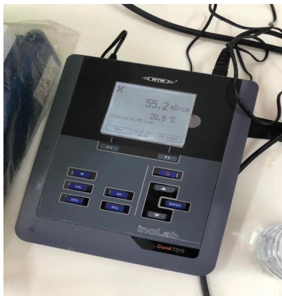
Figure N°9. Mesure de la conductivité avec un conductimètre (Photo Originale)
