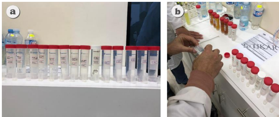
Figure N°12. Disposition des échantillons et des creusets (a) et remplissage des creusets de 5 mL avec les échantillons (b) (photos Originale)
