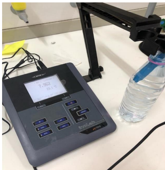
Figure N°8. Mesure du pH avec un pH-mètre (photo Originale)
