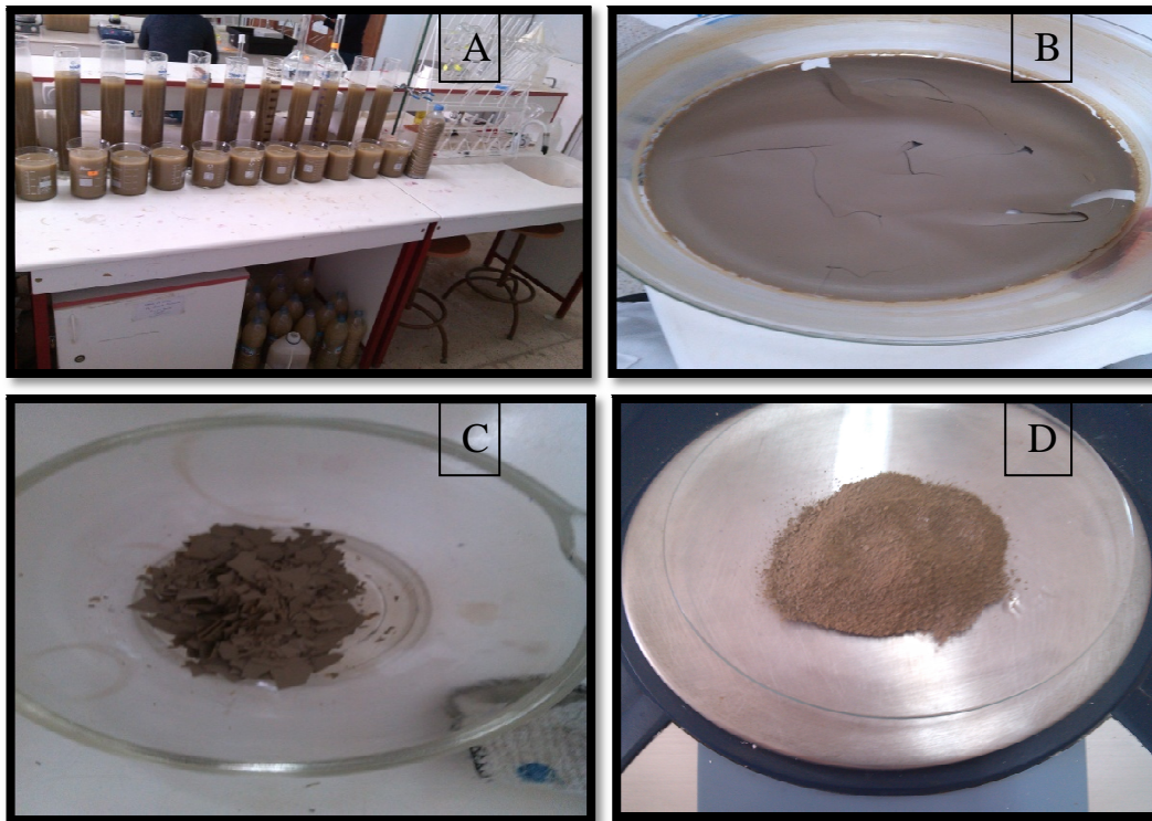
Figure III.1: Etapes suivies lors de la préparation de l'argile. A : décantation B et C : séchage D : poudre broyée
