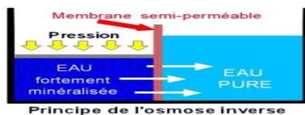
Figure II.1 : principe de l'osmose inverse [23].
