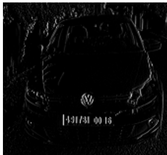
FIGURE 5.3 – Application de l'opérateur de Sobel
