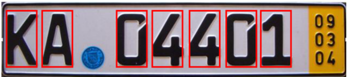
FIGURE 3.10 – Image transformée par l'OCR (segmentée)
