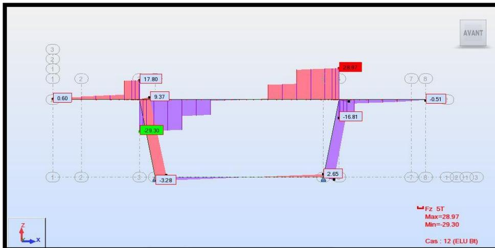
Figure VII.10. Diagramme des efforts tranchants à l'ELU (Section à la clé)
