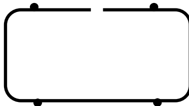
Figure II.43 : la forme de la pièce après le cintrage externe.
