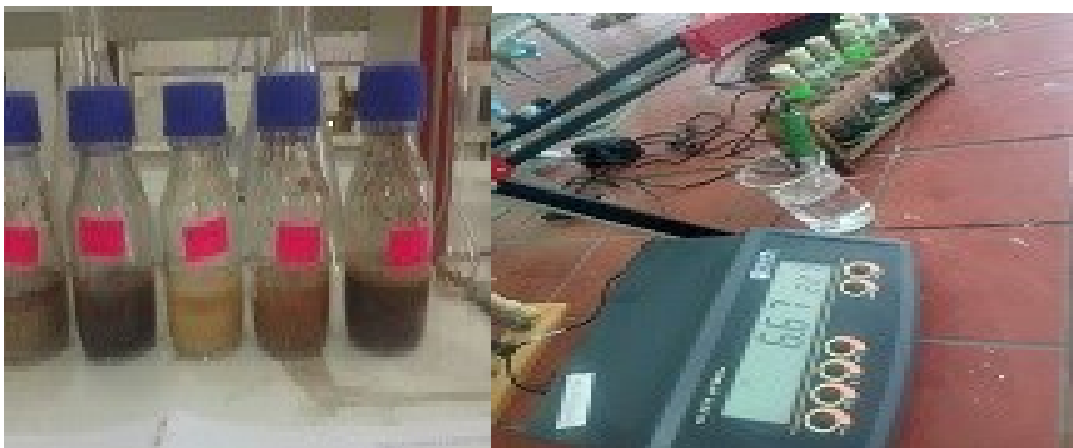
Figure (22) : les étapes de mesure du pH {originale 2022}
