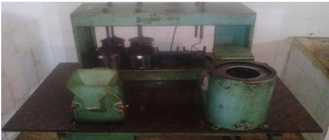
Figure 7: Oléodoseur du laboratoire de l'institut technique d'arboriculture fruitière(ITAF) Sidi Aiche(Bejaia).
