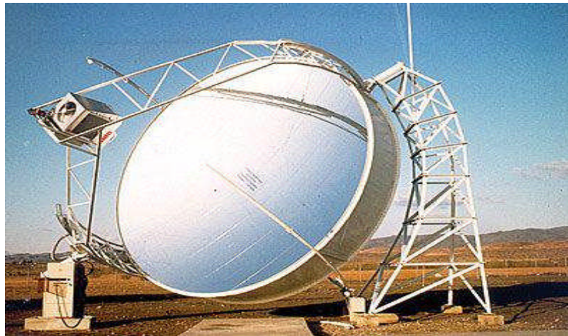
Figure.II.5 : Capteur parabolique avec moteur Stirling. [5]
