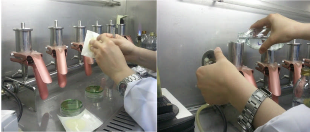
Figure (14) : Rampe de filtration (Photo original).
