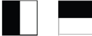
Figure 2.7. Ondelettes de Haar suivant les directions horizontale et verticale (zone noire: -1, zone blanche: +1)
