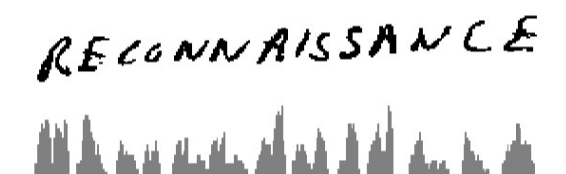
Figure 1.11. Calcul de l'histogramme de projection verticale [37]
