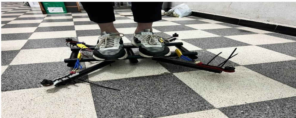
Figure III.9 : Test de la résistance du châssis a la charge
