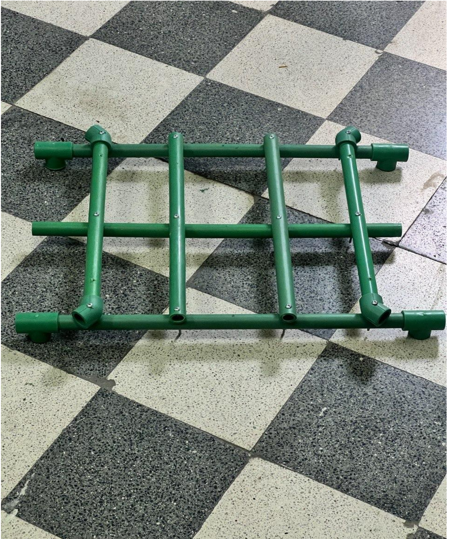
Figure IV.1 : Structure du châssis proposé
