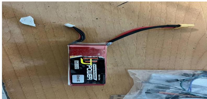
Figure III.18 : Batterie LiPo 4s 25C 14.8V
