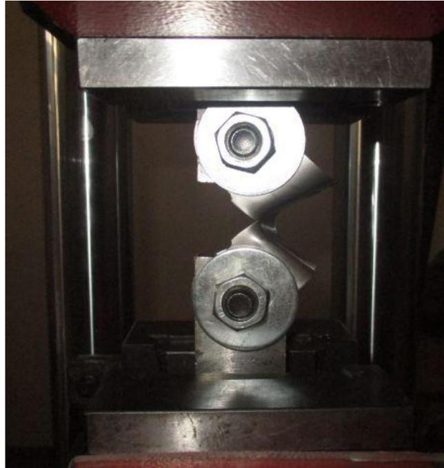
**Figure II.29)** Essai CT en utilisant le dispositif adapté à la machine de traction
