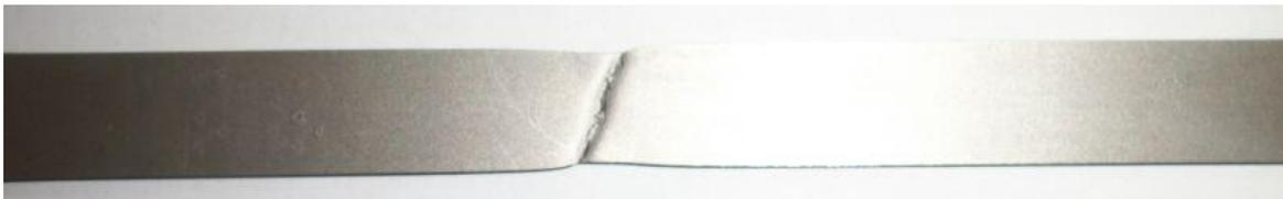
**Figure II.23)** Rupture de l'éprouvette de traction
