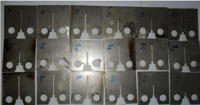
Figure II.28) Eprouvettes CT testées
