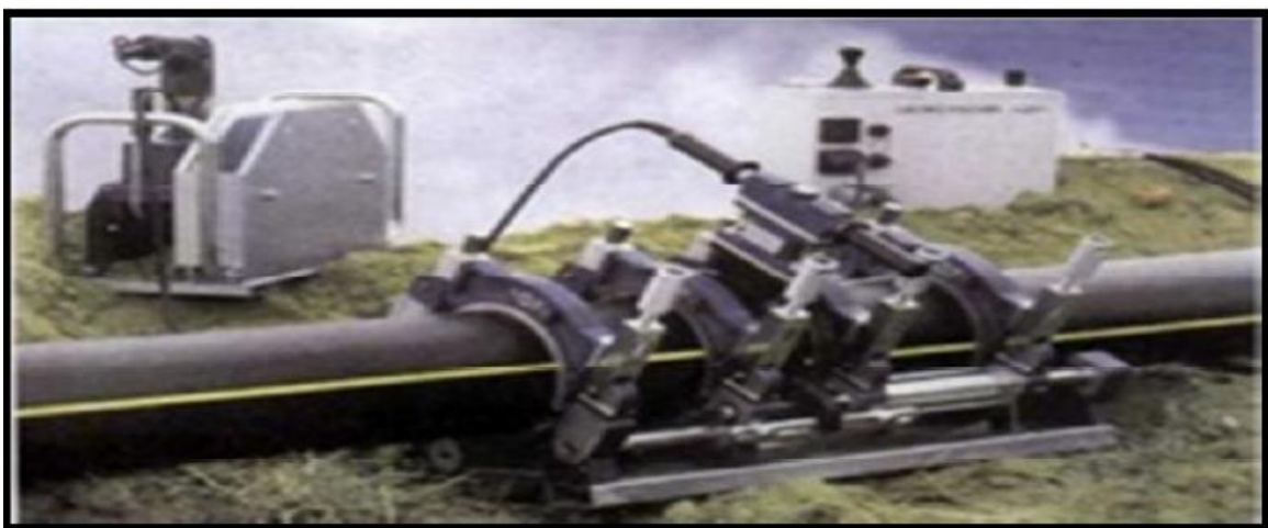
Figure (III.2): bout à bout « bouteuse »
