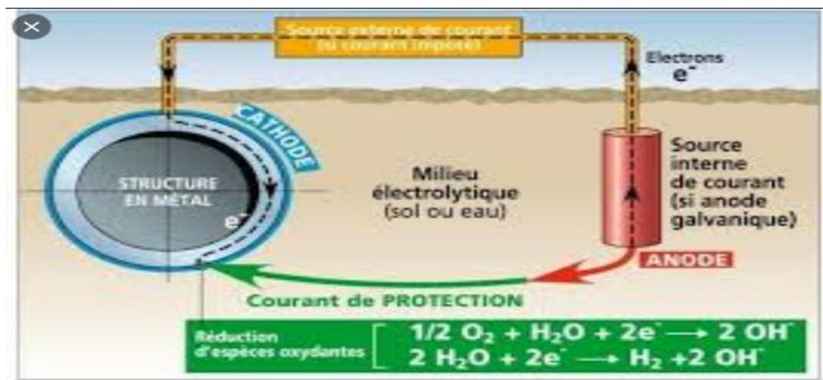
Figure (IV.16) : Protection cathodique
