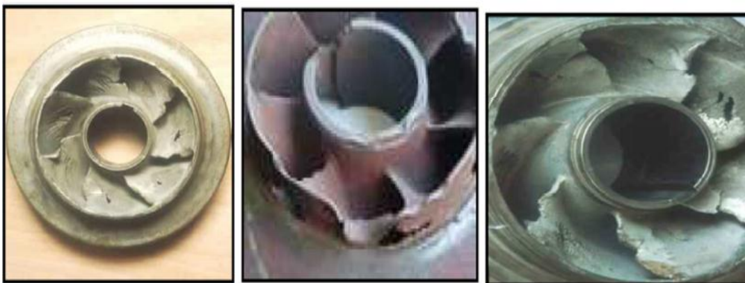
Figure(VI.8): Photos illustrant le phénomène de cavitation sur des aubes de pompe centrifuge
