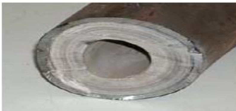
Figure (IV.14) : l'entartrage
