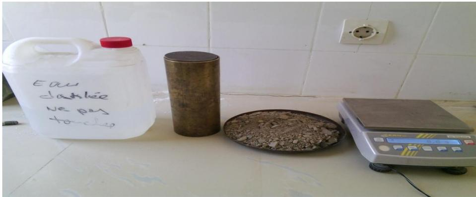
Figure IV.4: Matériel d'essai du pycnomètre en acier.
