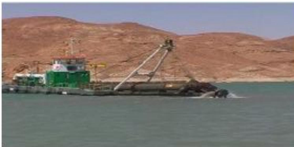
Figure II.10 : Dragage activant dans la retenue du barrage Foug-EI-Gherza (Biskra).
