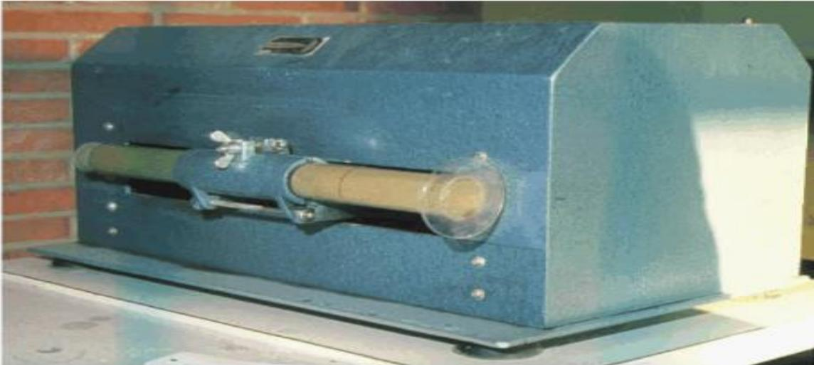
Figure IV.5: Appareillage d'équivalent de sable.
