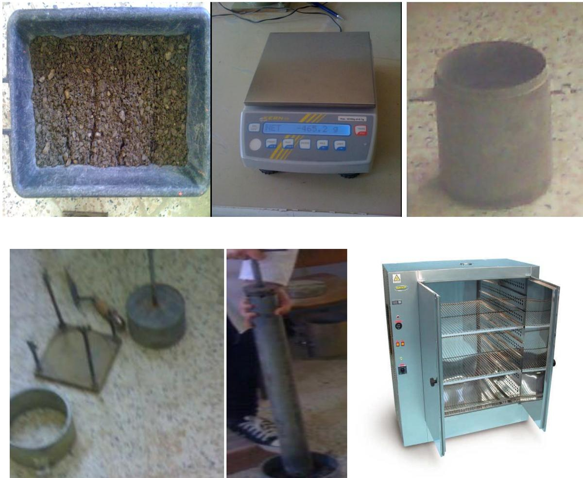
Figure VI.2: Matériel de confection des éprouvettes d'essai CBR.
