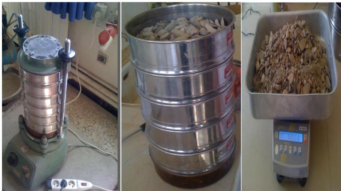
Figure IV.2 :Matériels d'analyse Granulométrique.
