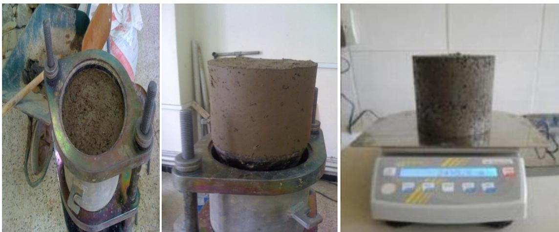
Figure V.10: Etape de démoulage du moule Proctor.
