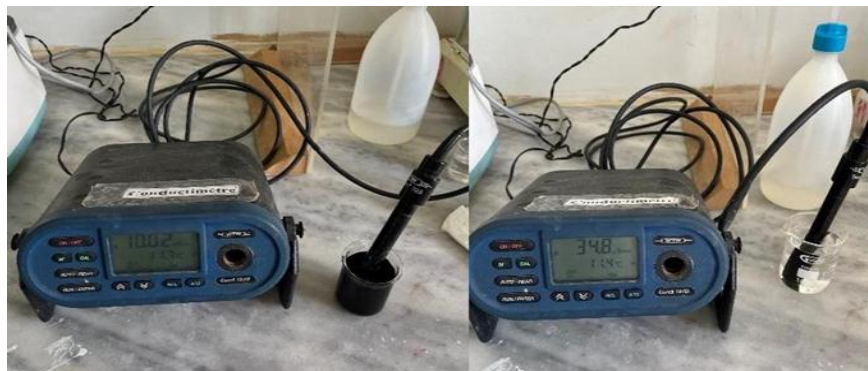
Figure 25 : Mesure de la conductivité du lixiviat à l'aide d'un conductimètre (Originale, 2025)
