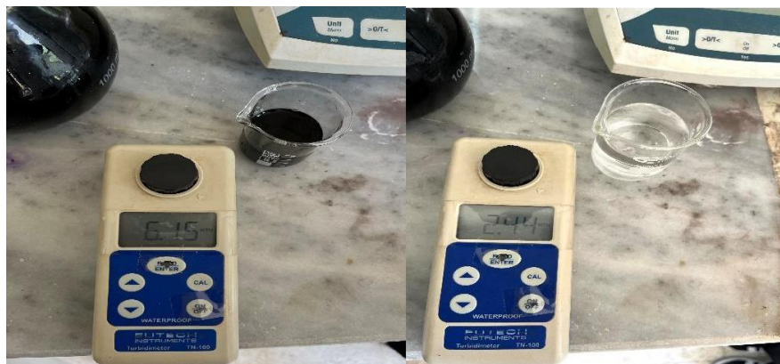
Figure 27 : Turbidimètre utilisé pour la mesure de la turbidité (Originale, 2025)
