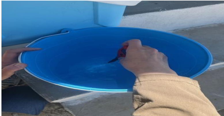
Figure 26 : Mesure du pH sur site à l'aide d'un pH-mètre (Originale, 2025)
