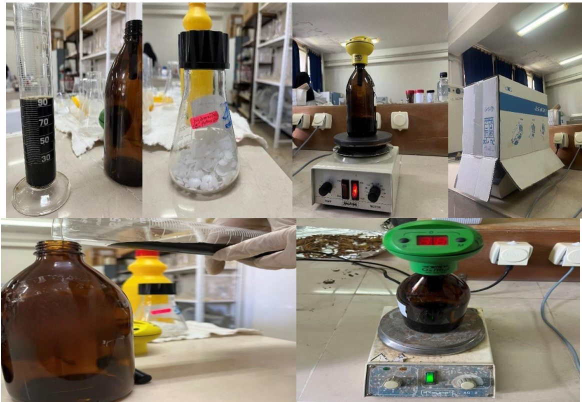
Figure 29 : Illustration de la mesure de la DBO_5 (Originale, 2025)
