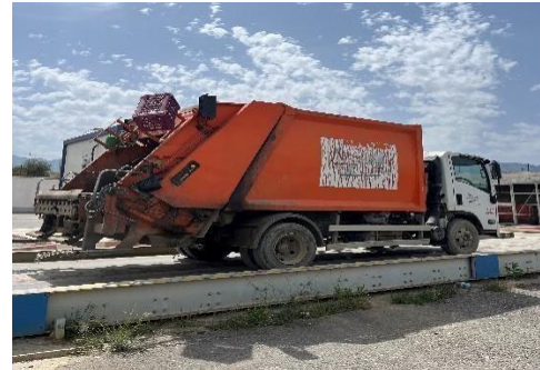
Figure 07 : Le pont bascule (Originale, 2025)
