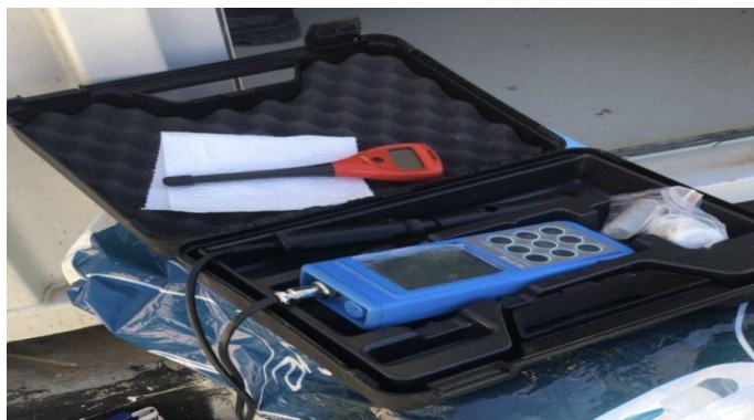
Figure 28 : Oxymètre utilisé pour la mesure de l'oxygène dissous (Originale, 2025).
