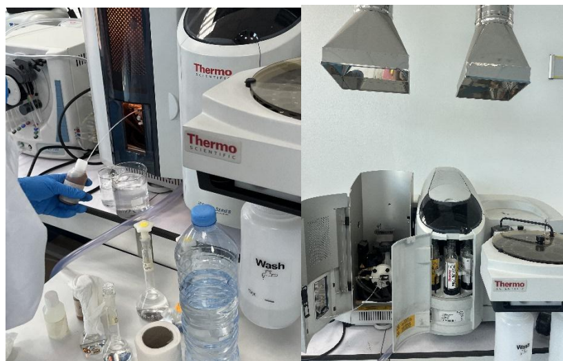
Figure 39 : Dosage des éléments traces métalliques par spectrométrie d'absorption atomiques (SAA-Four Graphite) (Originale, 2025)
