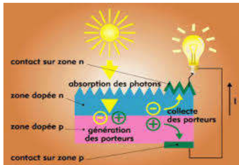
Figure II.1 : principe de la conversion PV.[9]
