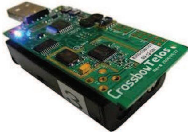
**Figure I.8** : Capteur TelosB.
