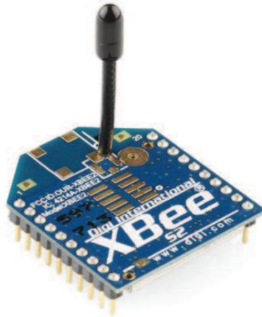
**Figure I.9** : Module XBee Série2.
