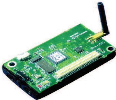
**Figure I.7** : Capteur MicaZ.
