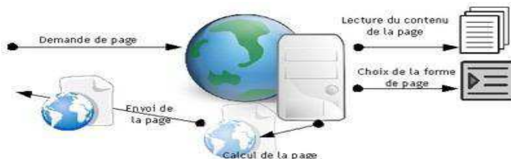
Figure 1.2: Fonctionnement d'un site web dynamique.
