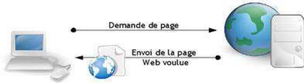
Figure 1.1 : Fonctionnement d'un site web statique.
