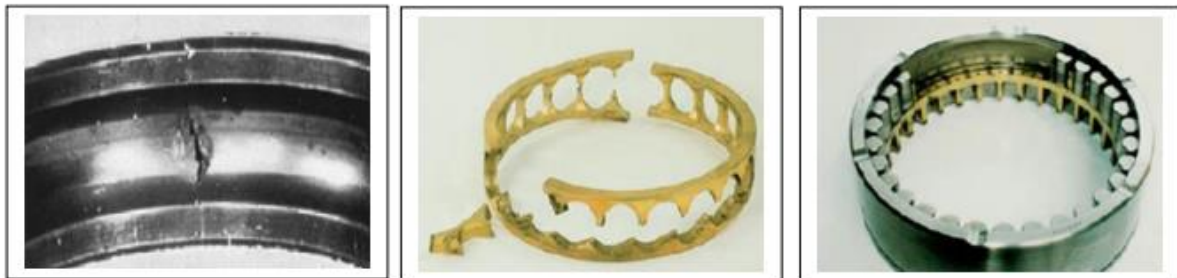
Figure II-22: Rupture des éléments d'un roulement
