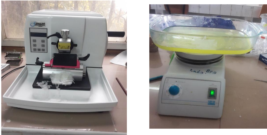
Figure 47 : Dispositif permettant de faire des coupes : microtome à gauche et bain marie à droite (Originale, 2022).
