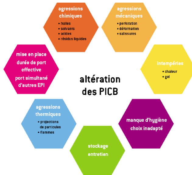
Fig. 4 : Paramètres d'altération des performances des PICB (INRS 2006)
