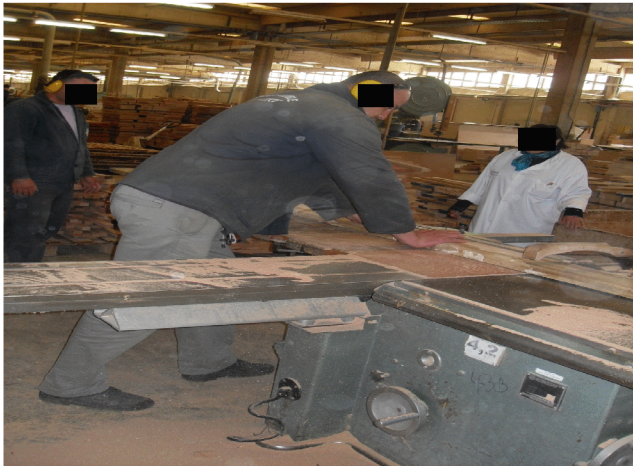
Photo 30 : Mise en marche de la scie
