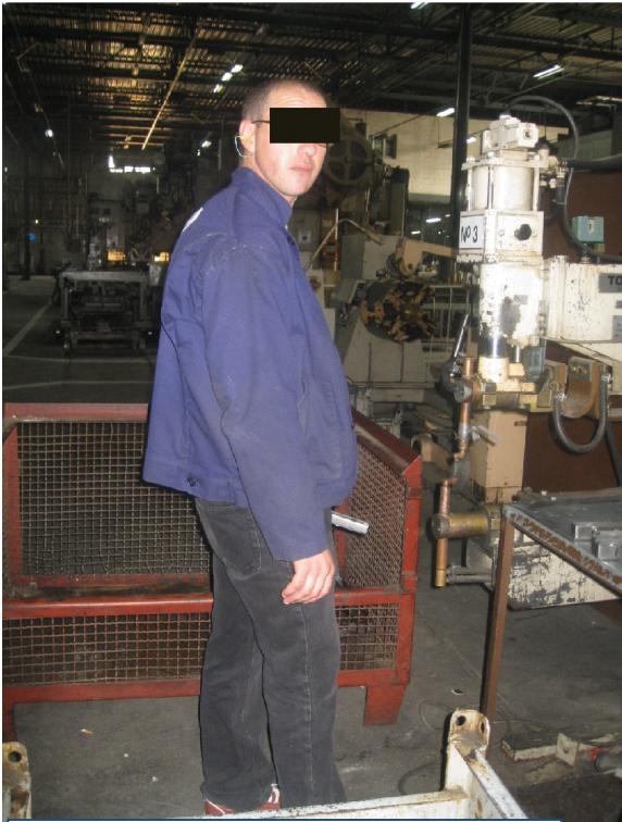
Photo 12 : Poste de soudeur par point
