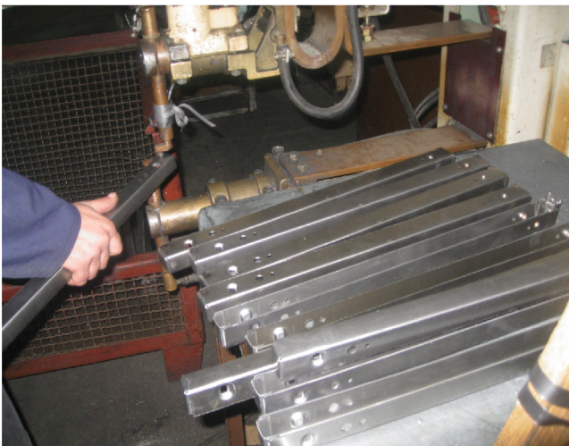
Photo 14 : Mise en place de la pièce sur l'électrode
