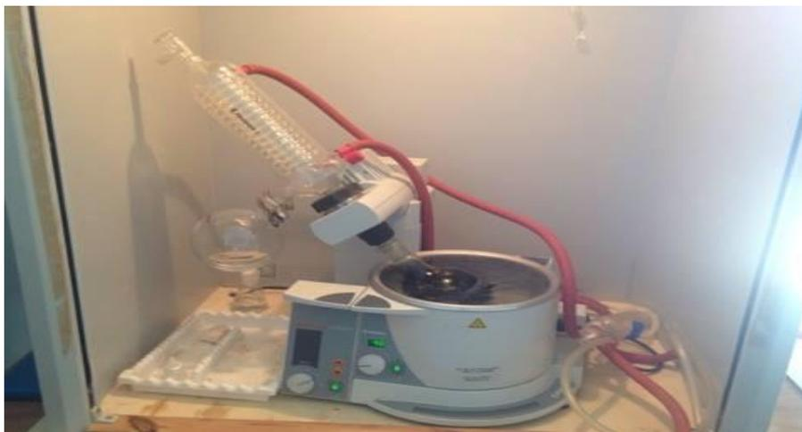
**Figure III.1 :** Dispositif de récupération du catalyseur par évaporation.
