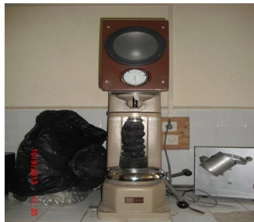
**Figure V.18** : Duromètre de type « WOPERT DIA TESTOR RC »
