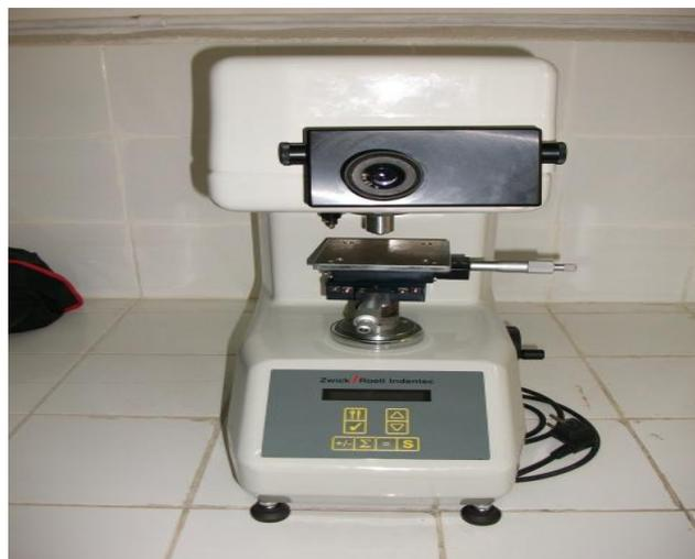
**Figure IV.21 :** Photo du microduromètre. [20]
