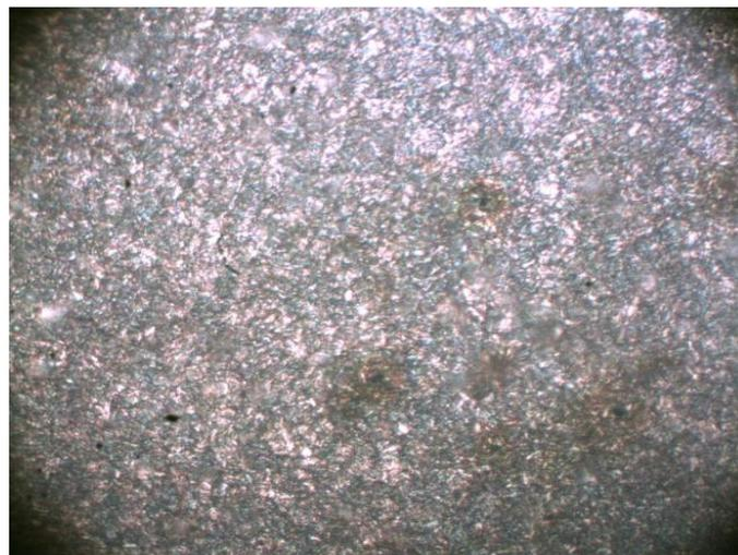
**Grossissement x200****Figure IV.16** : Micrographie de l'acier XC48 après traitement thermique.
