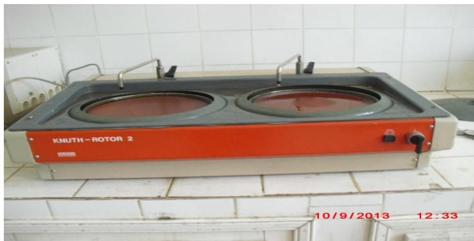
Figure IV.13 : Polisseuse du laboratoire SDM.
