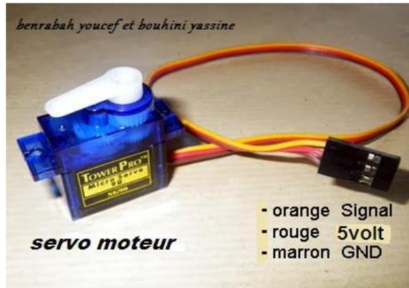
Figure II.7: Servomoteur simple.
