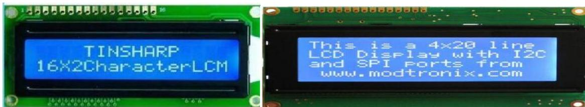
Figure II.6 : Afficheurs LCD (a) (16x2) (b) (20x4)
