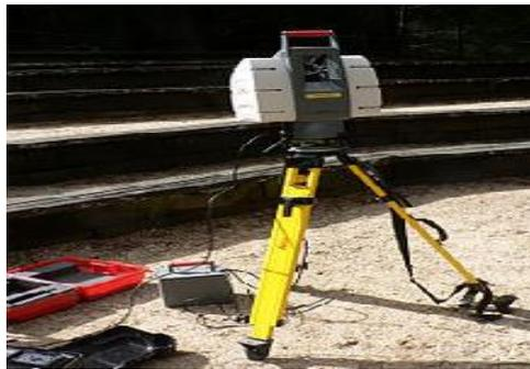
Figure I.3 : Lidars télémètres laser à balayage
