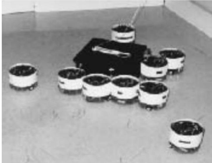
Figure 1.16. Exemple de collaboration entre plusieurs robots pour transporter un boîtier.
