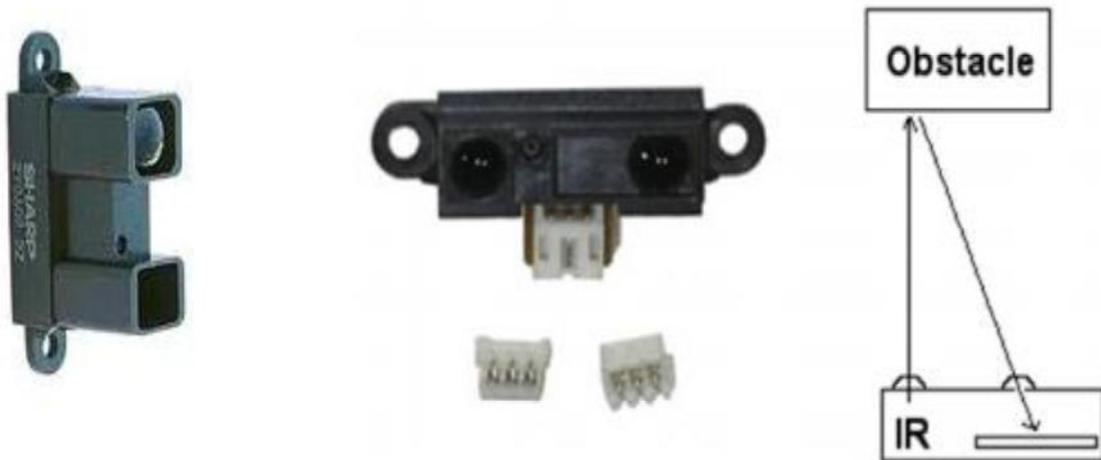
Figure 2.6. Principe du télémètre infrarouge à triangulation et exemple de télémètre réel.
