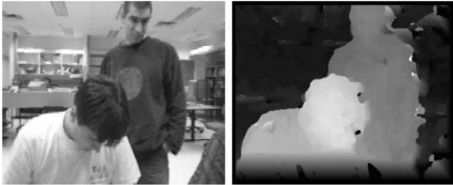
Figure 2.9. Exemple de données fournies par des caméras stéréoscopiques.
