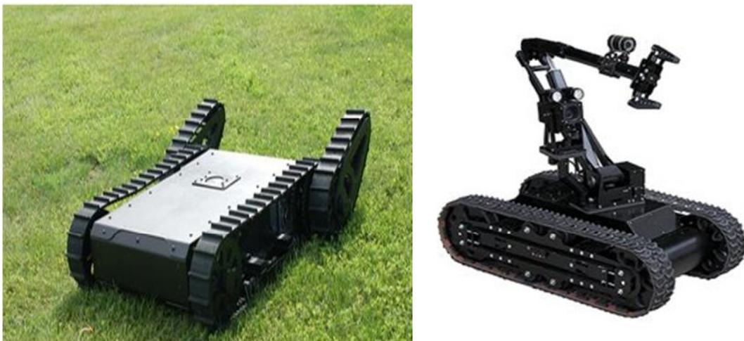
Figure 1.10. Exemples de robots mobiles à chenilles.
