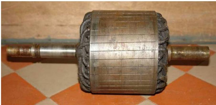
**Fig. I.4 :** *Rotor bobiné*
