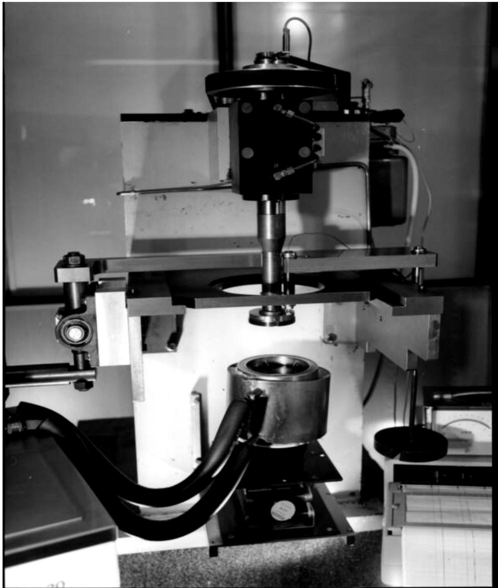
*Figure 1: Photographie du banc d'essai : Pion / Disque*
