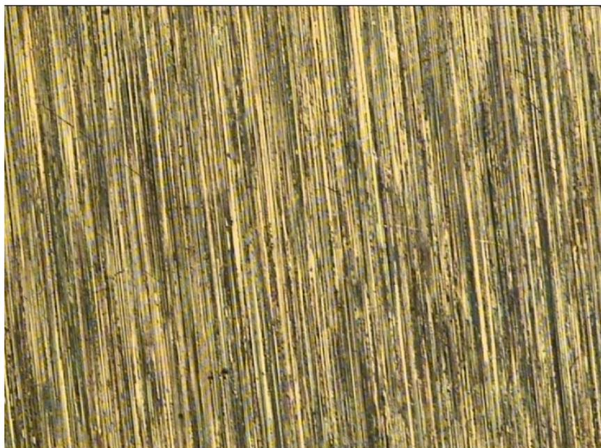
*Figure 24: Microphotographie de la surface du disque en 100Cr6 avant essai*
