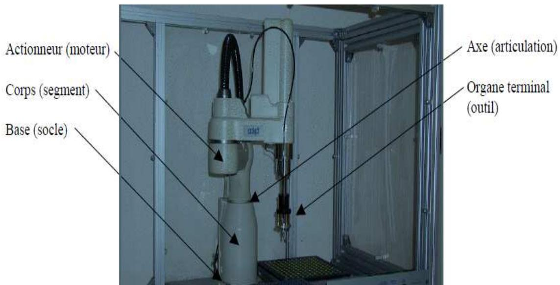
**Figure I.2.a :** Système mécanique d'un robot rigide
