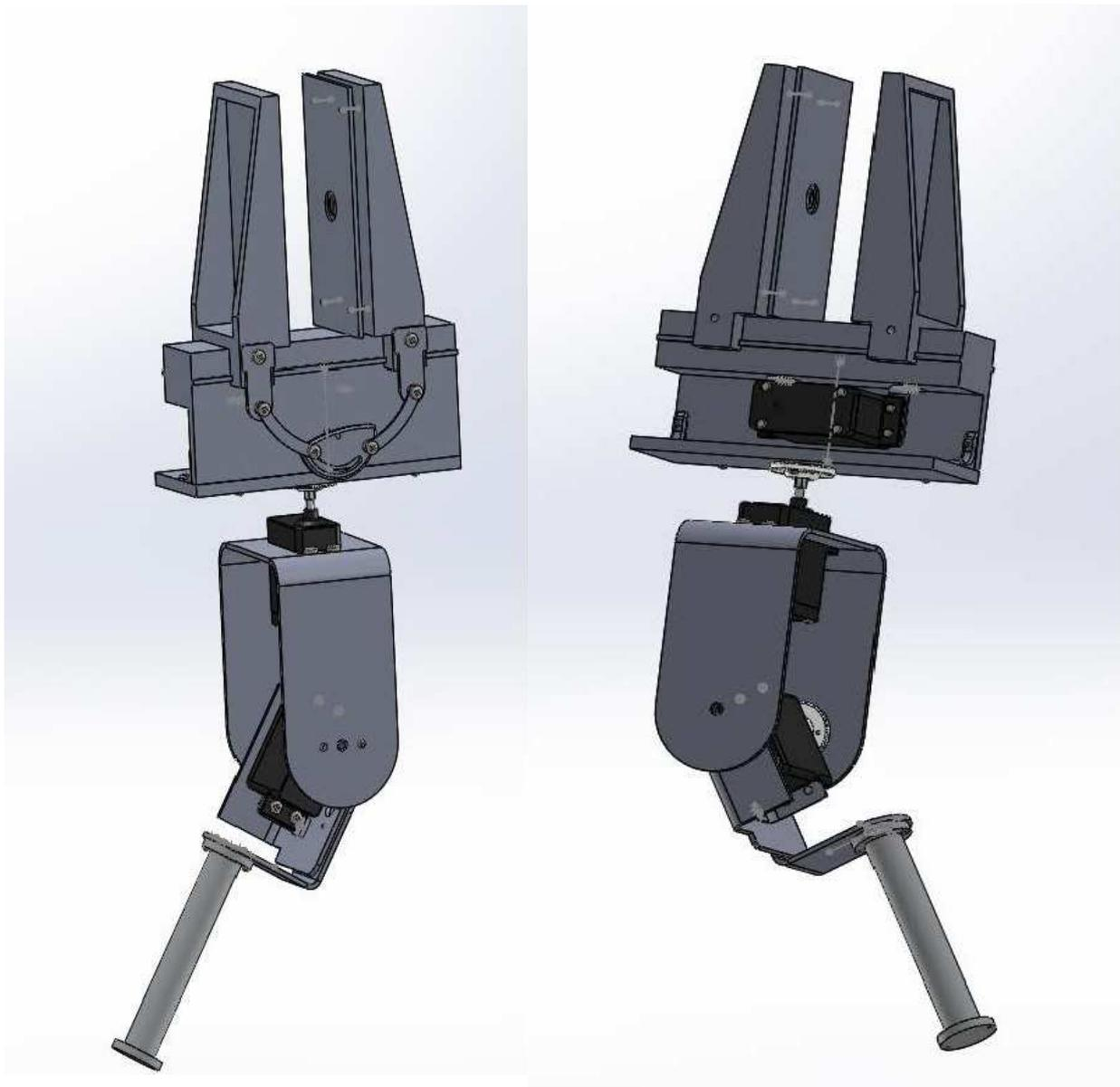
**a.** Vue de dessus**b.** Vue de dessous**Figure III.21 :** schéma de la pince à deux doigts.
