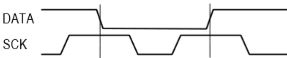
Figure n°24 : communication entre le MC et SHT75
