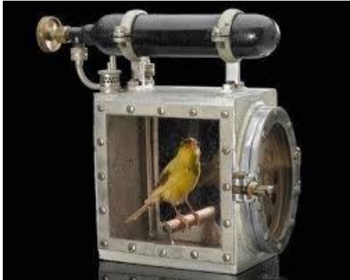
Figure n°01 – A gauche : boîte contenant un canari, le premier capteur de gaz connu. Utilisé dans les mines pour détecter la présence de méthane ou de monoxyde de carbone. La bouteille d'air comprimé permet de maintenir l'oiseau en vie. A droite : une lampe de sûreté, utilisée comme alternative au canari. Elle représente le premier capteur de gaz artificiel de l'histoire.
