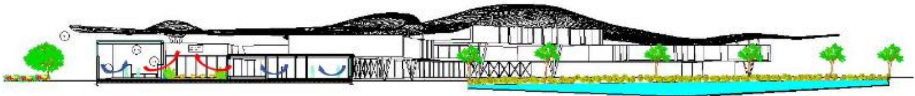
Figure 179 : La ventilation transversale
