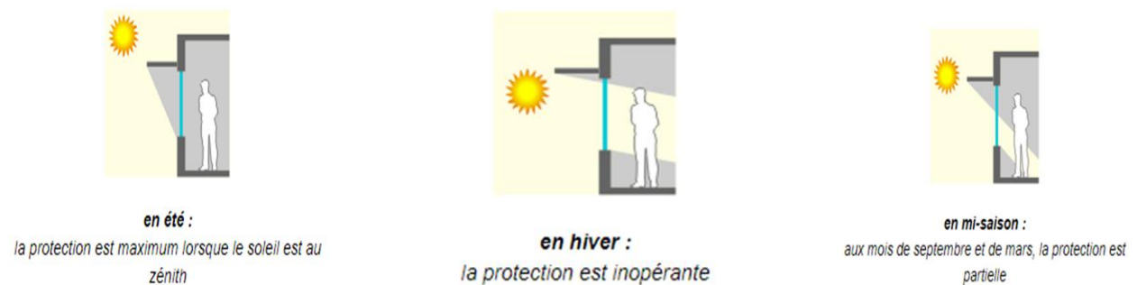
Figure 13 : Les protections solaires selon les saisons.
