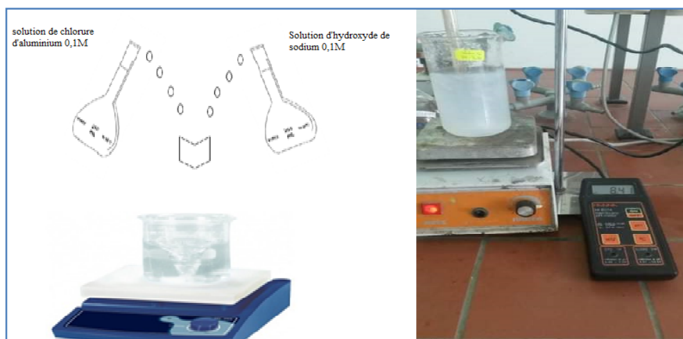
Figure II.2: Protocole expérimental suivi pour synthétiser \text{Al}(\text{OH})_3 par la méthode de précipitation
