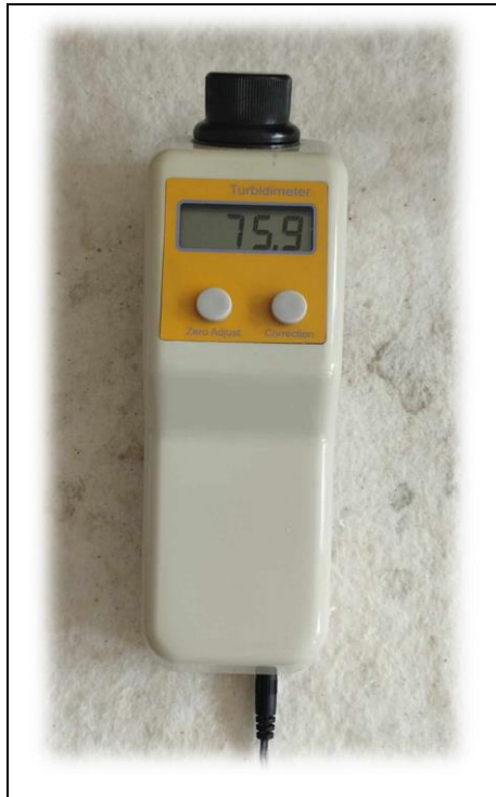
Figure 16. Mesure de turbidité par le turbidimètre.
