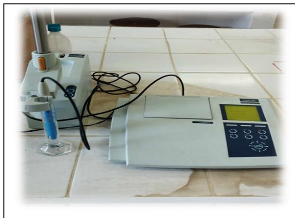
Figure 10. Mesure du pH par un pH mètre.
