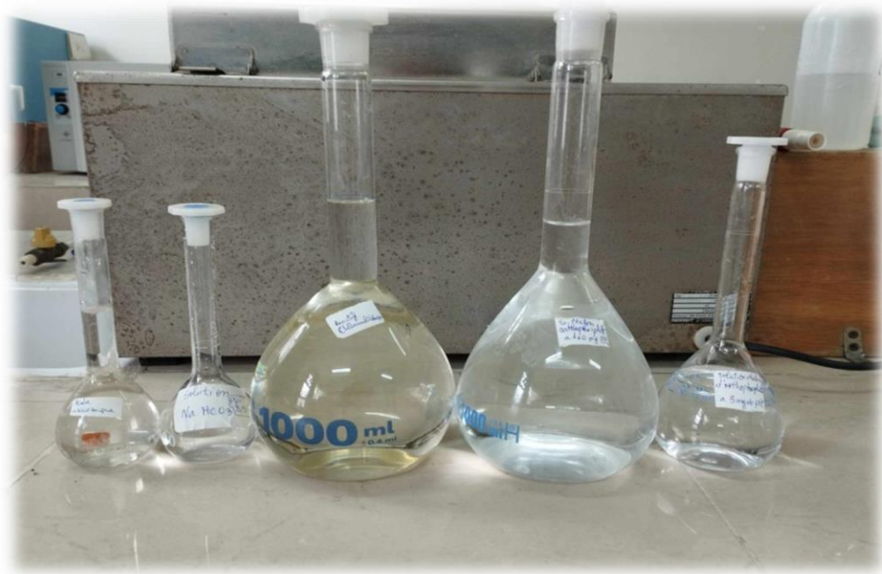
Figure 11. Solutions préparés pour mesure le phosphore.
